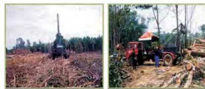
Penyaradan kayu dengan forwarder (kiri) - alat berjalan di atas residu tebangan untuk mengurangi pemadatan. Penyaradan kayu dengan kabel ( kingkong ) - bagus untuk lahan miring atau luas tebangan yang relatif kecil
