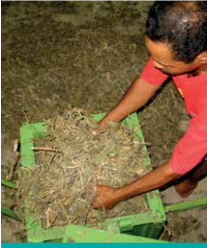
Gambar 30: Hijauan legum ditempatkan ke dalam boks kompresi alat press yang dioperasikan dengan tangan.
