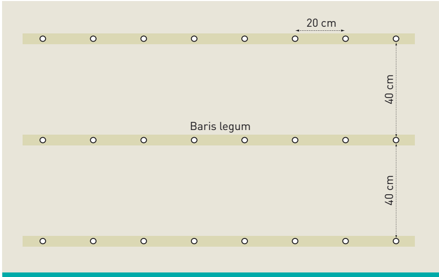
Gambar 20: Konfigurasi tugal untuk legum yang ditanam sebagai tanaman tunggal sebagai bagian dari sistem rotasi dengan jagung (atau padi).
