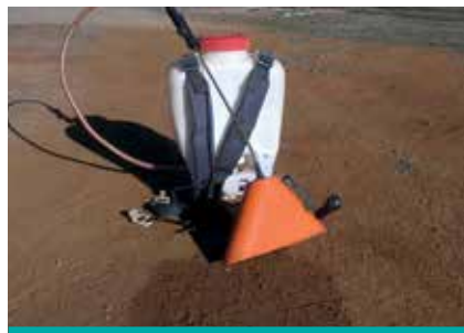
Gambar 25: Sprayer panggul berperisai digunakan untuk mengendalikan gulma antar baris dengan herbisida seperti glifosat dan paraquat.
