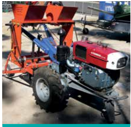
Gambar 17: Alat tanam benih buatan Australia dipasang pada traktor roda dua.
