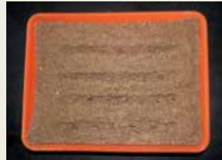
Nampan dangkal dengan lubang drainase di bawah digunakan untuk uji perkecambahan.
