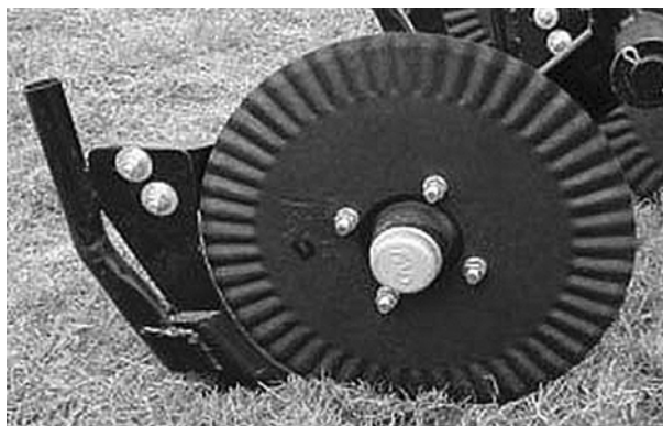
شکل ۲۱. پیش بر بشقابی شیاردار برای برش خاک و بقایای گیاهی.
