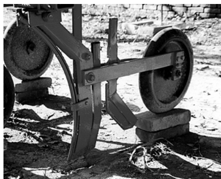
شکل ۱۶۰. یک شیاریازکن که در آن برای کنترل عمق از بازوی کشنده و چرخ تنظیم عمق عقب‌سوار استفاده می‌شود.
