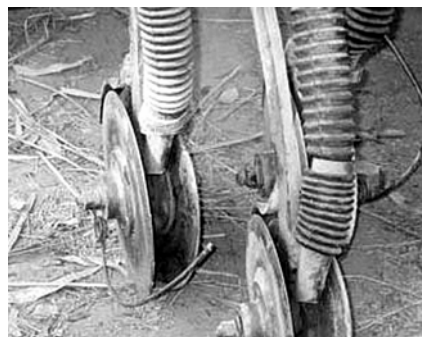
شکل ۷۷. قرارگیری بذر داخل شیار از لوله سقوط که در بالای کف شیار خاتمه می‌یابد.
