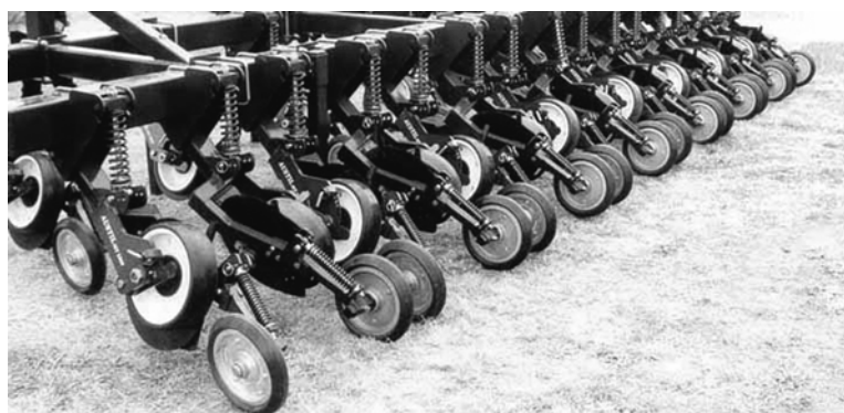
شکل ۶۶. شیاربازکن‌هایی که در جفتهای متضاد یکدیگر در کل عرض ماشین مرتب شده‌اند.
