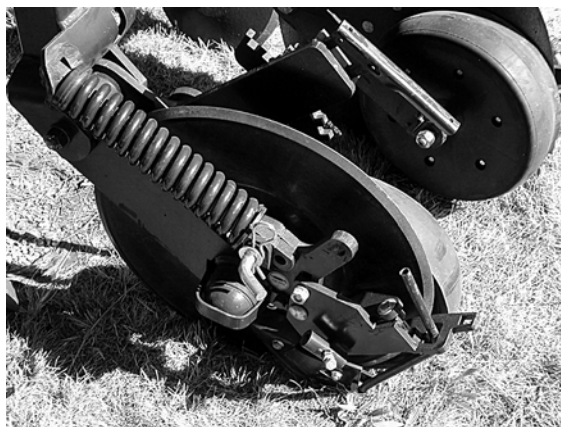
شکل ۱۶۱. یک شیاربازکن که در آن کنترل عمق با بازوی کشنده و چرخ تنظیم عمق اختصاصی است.
