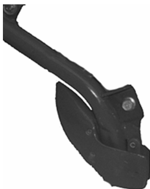
شکل ۹۴. شیاربازکن کفشکی که سمت عقب آن انحنا دار است و ابزار قراردهی بذر به‌کاررفته در آن.
