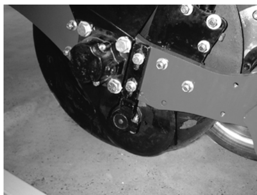
شکل ۷۰. ابزار قراردعی بذر در شیار از نوع دیسک چرخان در یک شیاربازکن تک‌بشقابی تک‌زاویه‌ای.
