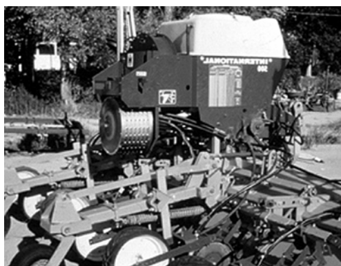
شکل ۱۹۶. نمای عقبی یک واحد موزع استوانه‌ای دمشی.
