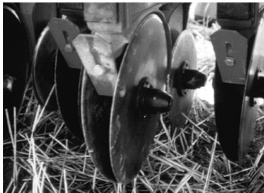
شکل ۸۰. نمای عقبی یک شیاربازکن سه‌بشقابی یکپارچه.
