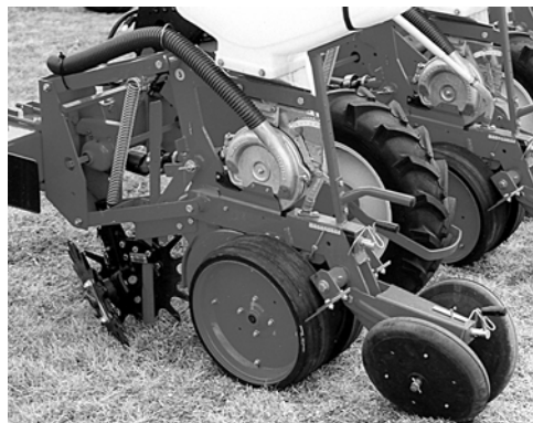
شکل ۱۵۵. یک ردیف‌کار که در آن برای کنترل عمق از چرخ‌های تنظیم عمق اختصاصی (مجاور شیاربازکن) استفاده می‌شود.
