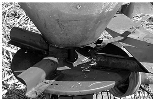
شکل ۲۰۴. سیستم تحویل بذر کمک مکانیکی از نوع صفحه‌چرخان.
