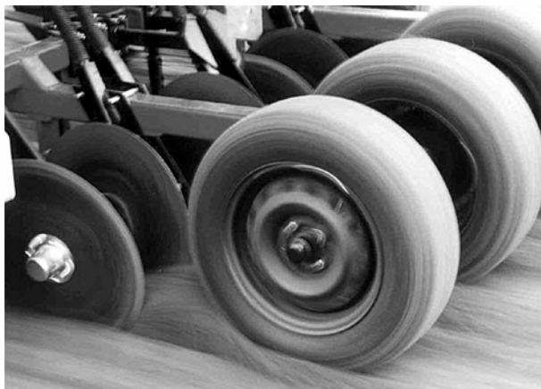
شکل ۶۸. شیاربازکن‌های تک‌بشقابی مقابل هم که یک چرخ فشار مشترک دارند.
