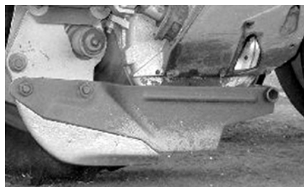
شکل ۵۱. نمونه‌ای از شیاربازکن کفشکی کامل.
