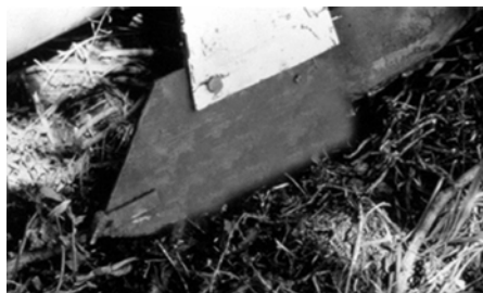
شکل ۵۲. نمونه‌ای از شیاربازکن کفشکی ناکامل.
