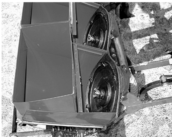
شکل ۱۸۱. صفحات موزع مایل دوتایی که یک لوله سقوط را تغذیه می کنند.
