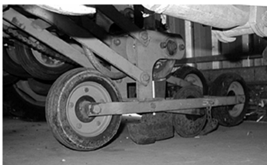
شکل ۱۵۷. یک شیاربازکن که در آن برای کنترل عمق از قاب متوازی الاضلاع و به کارگیری چرخهای تنظیم عمق دوتایی (جفت چرخ) استفاده می شود.
