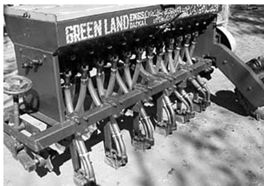
شکل ۲۰۳. تحویل بذر به وسیله نیروی ثقل و از طریق لوله های سقوط بلند در خطی کارها.
