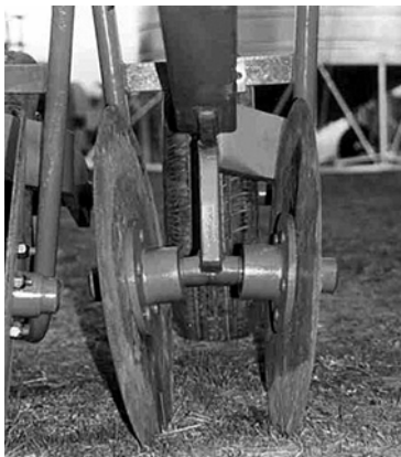
شکل ۶۷. شیاربازکن‌های تک‌بشقابی زاویه ترکیبی که به حالت متضاد روی محوری مشترک قرار گرفته‌اند.
