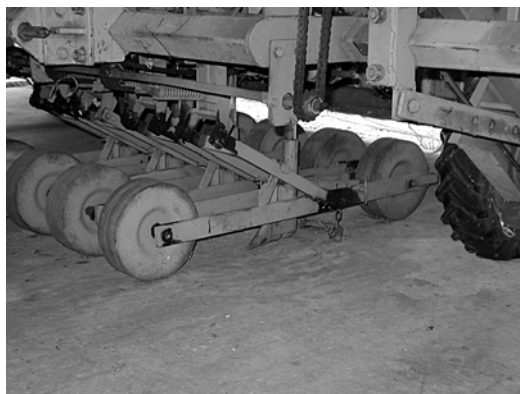
شکل ۱۶۲. کنترل عمق به کمک بازوی کشنده و سیستم جفت‌چرخ تنظیم عمق.
