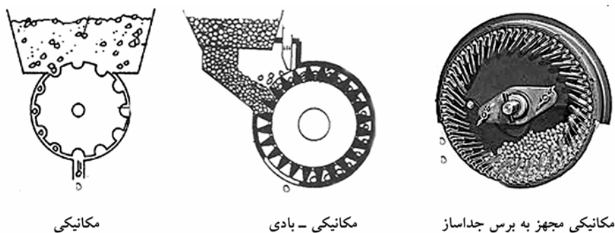
شکل ۱۸۲. انواع کلی موزعهای صفحه عمودی.
