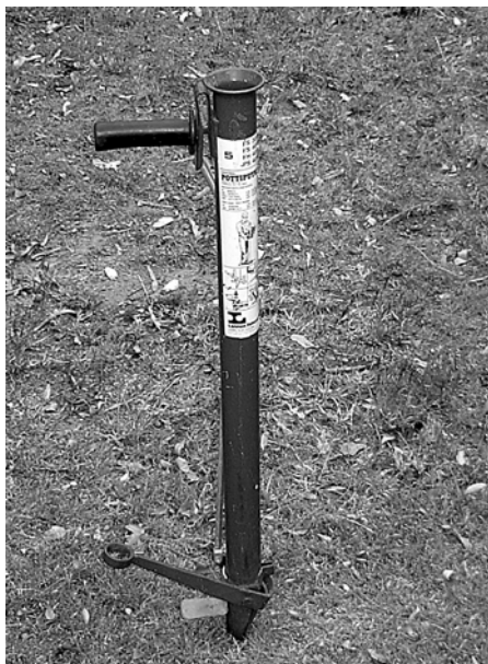
شکل ۱۳. کارنده سمبه‌ای دستی یک‌ردیفی که با دست انسان کار می‌کند.
