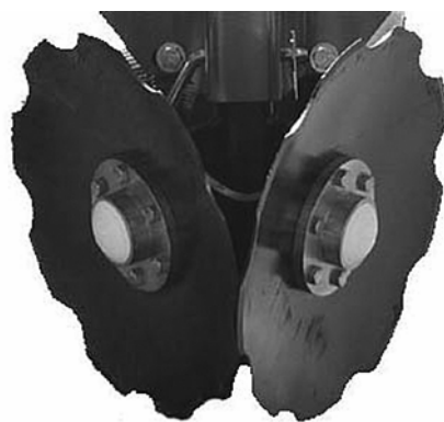
شکل ۳۶. نمونه‌ای از ردیف‌ساز دوبشقابی لبه‌کنگره‌ای.
