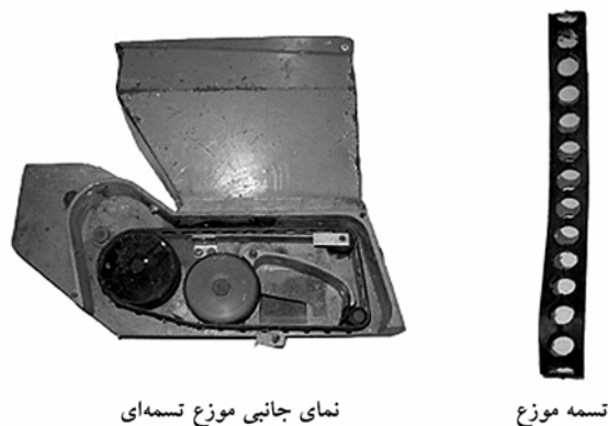
شکل ۱۹۲. نمای جانبی یک موزع تسمه‌ای که صفحه پوشاننده جانبی آن برداشته شده است.
