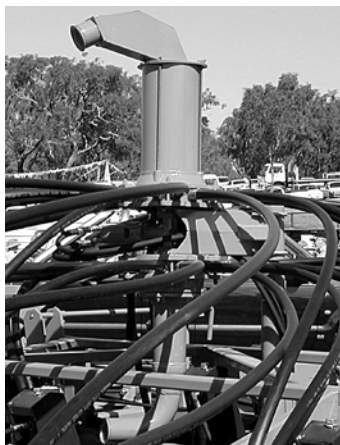
شکل ۲۱۱. مقسمهای بذر و کود متشکل از اجزای متحرک هیدرولیکی.
