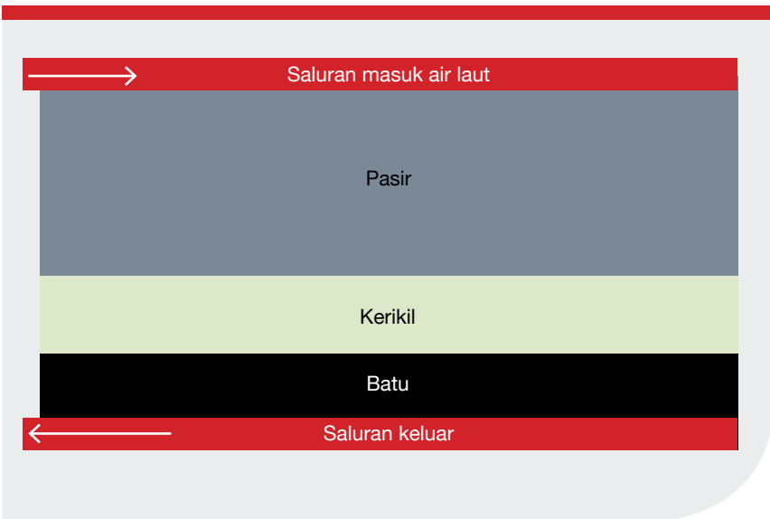
Gambar 18 Diagram penampang melintang saringan pasir menunjukkan pengaturan substrat secara bertahap dan konfigurasi saluran air masuk dan keluar
