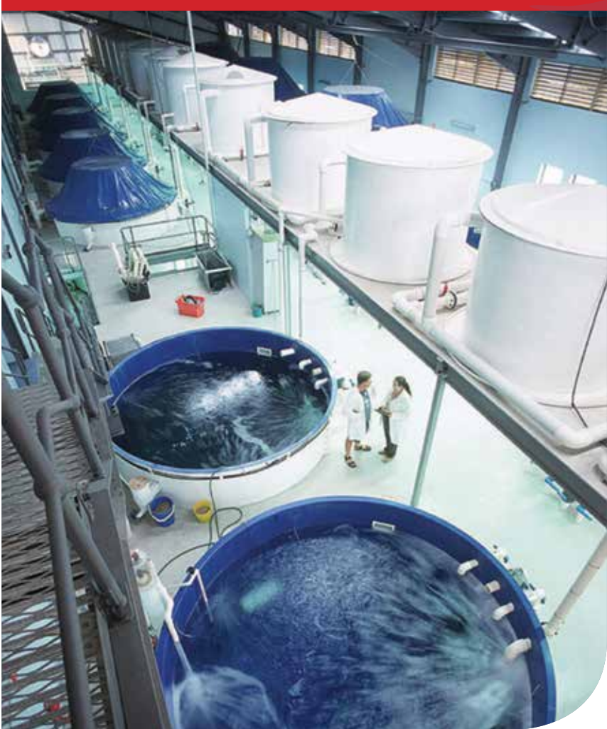
Gambar 9 Tangki fiberglass digunakan untuk menampung indukan kerapu macan di Northern Fisheries Centre , Cairns, Queensland, Australia. Tangki-tangki di bagian depan mempunyai volume sekitar 20 m 3 dan masing-masing dilengkapi dengan sistem resirkulasi yang terdiri dari filter biologis (tangki putih yang ditaruh di atas) dan sistem ozon untuk menjaga kualitas air, dan penukar panas untuk menjaga suhu air. Sebagian tangki tersebut tertutup (di latarnya) dan dilengkapi dengan sistem pencahayaan yang dikendalikan komputer untuk mengatur panjang hari serta suhu air. (Foto: Queensland Department of Primary Industries and Fisheries )
