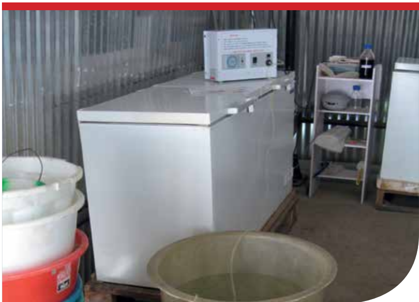
Gambar 13 Pembangkit ozon (disimpan di atas lemari pendingin) dan tangki air laut yang siap untuk mencuci telur kerapu. Telur dicuci dalam satu tangki (di depan), kemudian dibilas dalam tangki kedua (tidak terlihat). (Foto: M. Rimmer)
